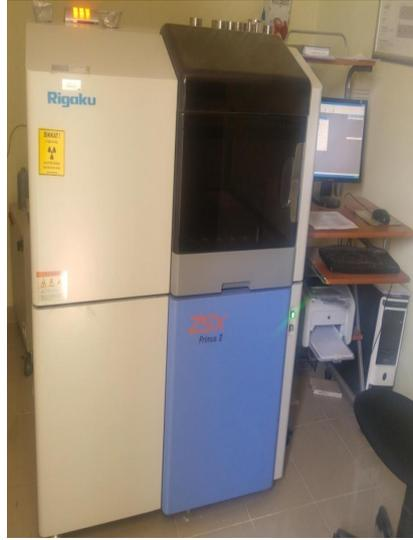
*Şekil 4. Kimyasal Analiz (XRF) cihazı.*
