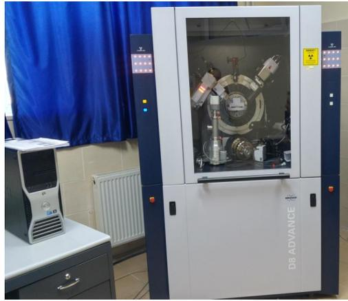
*Şekil 5. Mineralojik Analiz (XRD) cihazı.*
