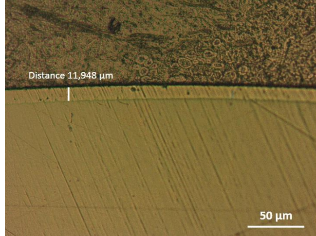
Şekil 5. Krom kaplı C45 milin ve kaplama tabakasının kesit optik mikroskop görüntüsü (kalınlık ~12 µm)
