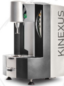
Kinexus Reometre / DSR cihazı
