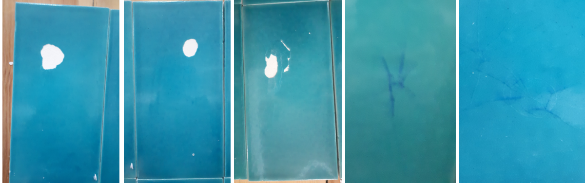
Fotoğraf 4. D firmasına ait çini örneklerinin dona dayanım testi sonrası görünümü.
